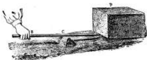
Palanca. — B, potencia; C, punto de apoyo; P, resistencia.
